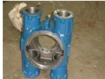
**HYDRAULIC TORQUE CONVERTER**
